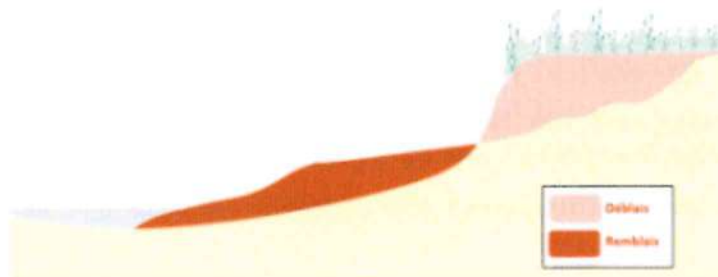
Figure 316 : Illustration du remodelage des berges de l'ancien plan d'eau
