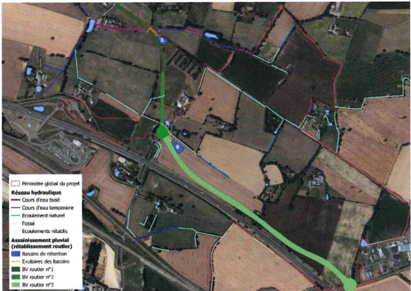
Figure 289 : Assainissement pluvial du rétablissement de la RD131
